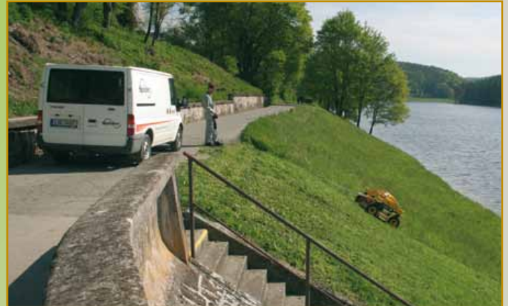
Sehr flexibel im Einsatz. Mit dem Transporter zum Einsatzort, ausladen, im Steilhang den Spider noch mit der Winde sichern und schon gehts los.
